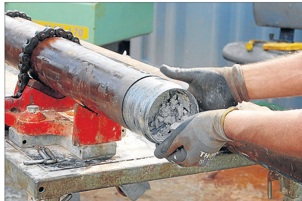
Plastikrøret med kernen sidder inden i det stålør, der er blevet skudt ned og hentet op af undergrunden.
