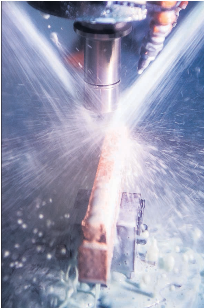
Kellpo kan håndtere alle processer i værktøjsfremstilling til plastindustrien. Spåntagning er et af specialerne på Kellpo. Her er det en gnistelektrode til værktøjsfremstilling, der finpudses.
